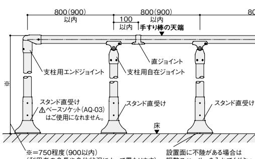
※手すり棒を仮止めする際は、必ず2個以上の支柱へ手すり棒をのせて作業を行ってください。
