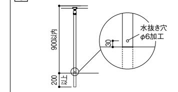
※埋め込み支柱とする場合は必ずパイプ内にたまつた水を抜くための水抜き穴φ6mmをあけてください。支柱や埋め込み部分の被損の原因となります。
